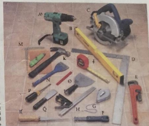
A – bormașină portabilă cu acumulator; B – boloboc; C – ferăstrău circular; D – echer pentru construcții; E – cheia reglabilă (mops); F – instrument de tăiere a plăcii de susținere; G – cutia de cretă; H – echer cu diferite unghieri; I – șpaclu de 15 cm; J – ruletă; K – ciocan; L – cutter; M – șmirghel; N – dalta; O – creion de tâmplar; P – șurubelniță; Q – cuțit pentru chit; R – mini-ferăstrău
