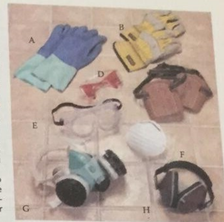
A – mănuși de protecție din cauciuc; B – mănuși de lucru; C – protectoare pentru genunchi (genunchiere); D – ochelari de protecție uzuali; E – ochelari mai mari de protecție; F – mască pentru reținerea particulelor; G – mască pentru a respira într-un mediu cu substanțe toxice; H – protectoare pentru urechi (antifoane)
