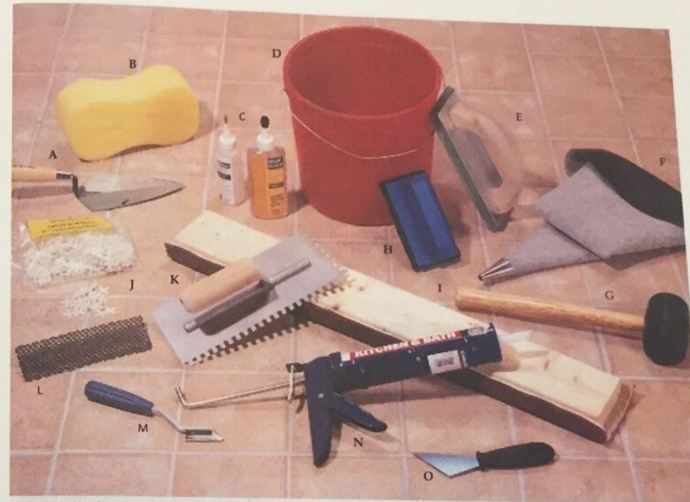
A – mistrie; B – burete neabraziv; C – flacon cu sigilant pentru chit + aplicator; D – găleată; E – gletieră netedă pentru chituire; F – aplicator de chit; G – ciocan de cauciuc; H – instrument de curățare a chitului; I – bucată de scândură; J – distanțiere; K – scândură zimțată; L – șmirghel suflat cu carborund; M – răzuitor de chit; N – pistol de silicon; O – instrument pentru îndepărtarea distanțierelor.
